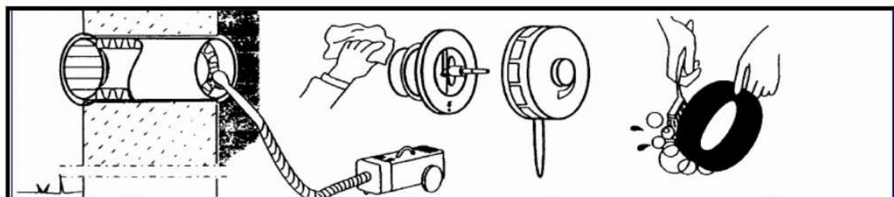
Разборка оголовка и извлечение фильтра
